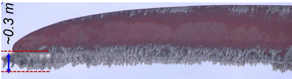
Figur 5 - Isbildning på plastbitar under isstorm i Texas, 2021, som sannolik orsak till varför dessa lossas från turbinblad efter erfarenheter dokumenterade även i Sverige 89, 90 .
